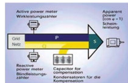
Abb.: Prinzip der Blindleistungskompensation
