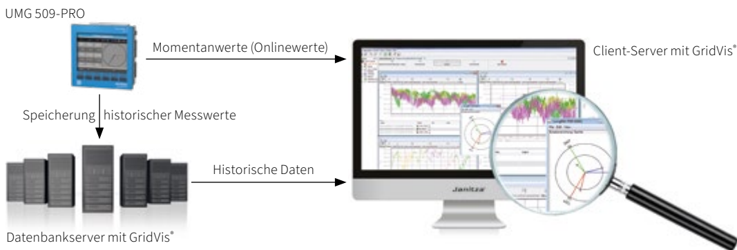
Abb.: Das UMG 509-PRO z. B. hat derzeit 6 Kommunikationsports. Davon sind zwei als Gateway (Port 8000) für nachgeschaltete RS485-Geräte ausgeführt.
