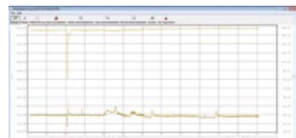
Abb.: Ereignisaufzeichnung Spannungseinbruch / Unterspannung
