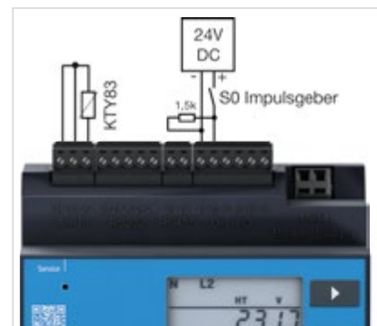
Abb.: Beispiel Temperatureingang (KTY83) und S0-Impulsgeber
